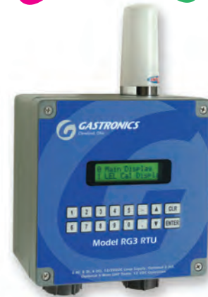
RG3 RTU ผสมผสานระบบการตรวจวัดก๊าซแบบไร้สายเข้ากับระบบการควบคุมและตรวจสอบแบบไร้สาย มีแอนะล็อกอินพุต 6 ชุด ดิจิทัลอินพุต 8 ชุด รีเลย์เอาต์พุต 4 ชุด และ RS232/485 (Modbus-RTU)
