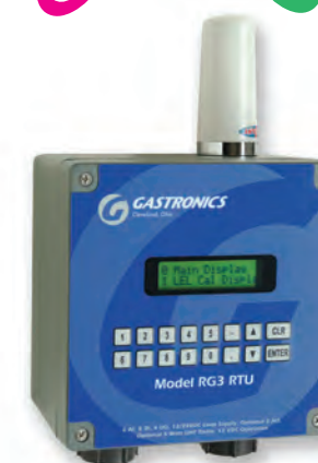
RG3 RTU Объединяет технологию беспроводного обнаружения газа с беспроводным контролем и управлением. Имеется 6 аналоговых входов, 8 цифровых входов, 4 релейных выходов и RS232/485 (Modbus-RTU)
